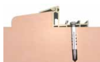
Fixation en rénovation
