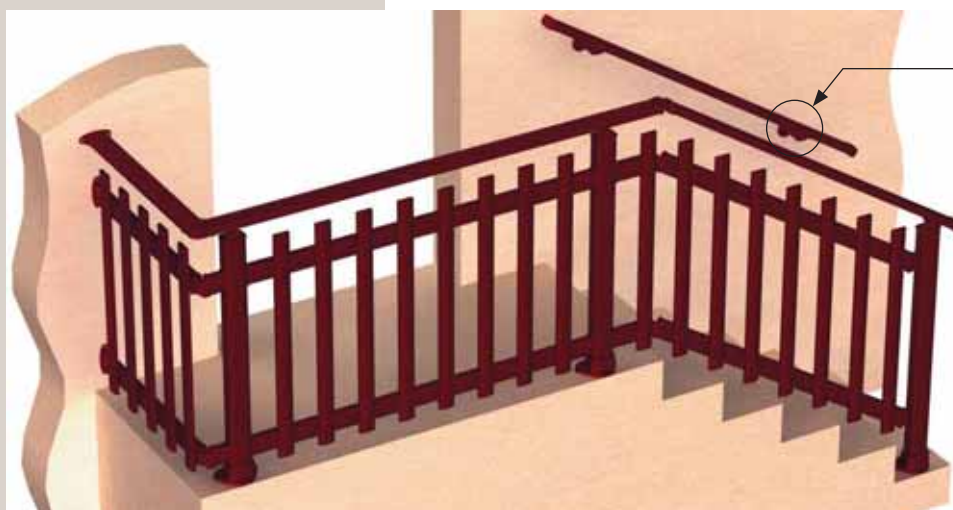
Fixation Main courante / Mur Entraxe maxi 1500mm
