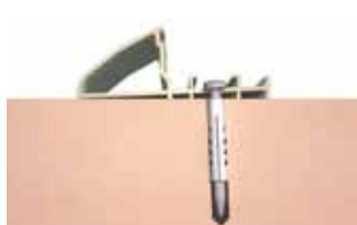
Fixation en neuf sur sol plat
