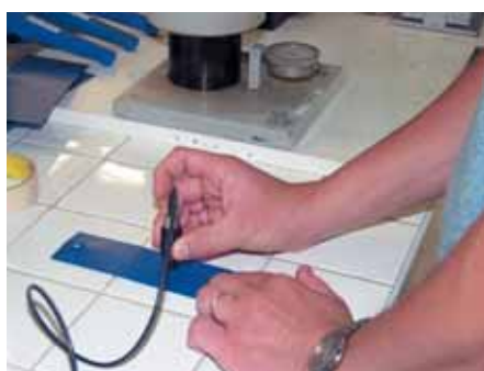
Contrôle de l'épaisseur du thermolaquage
